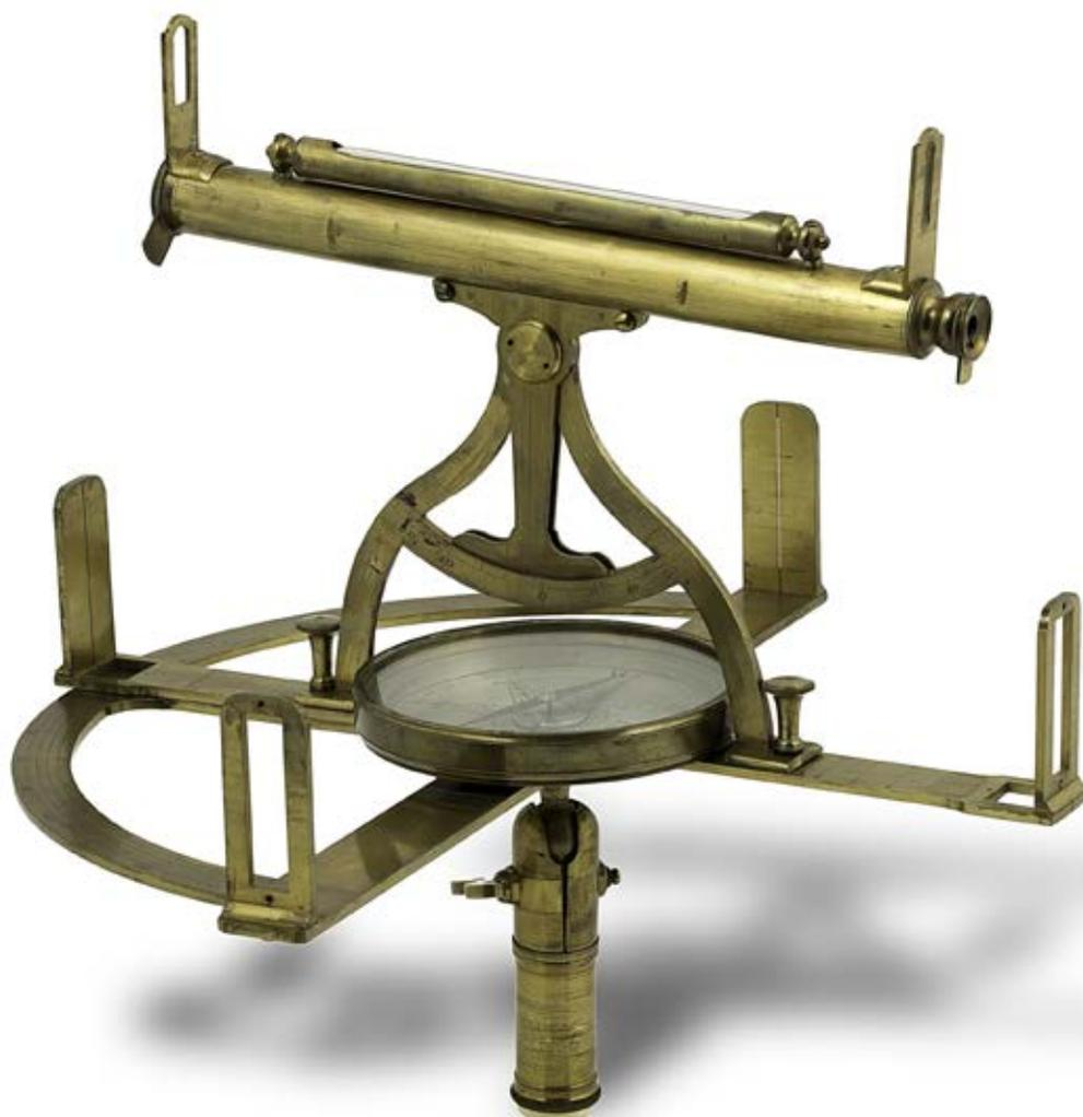
Le bras mobile du graphomètre porte des graduations et une échelle de dixme. Le limbe circulaire du graphomètre est divisé en 180° avec une division tous les 0,5°. La boussole est dotée d'une superbe rose des vents et porte les indications géographiques N, NW, W, SW, S, SE, E, NE. Comme la majorité des boussoles de l'époque, le nord est indiqué par une fleur de lys. La base du graphomètre est munie d'une rotule articulée pour être fixée sur un pied vertical.
