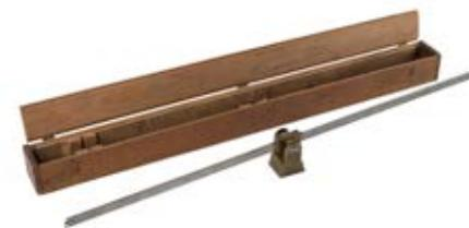
Fléau reposant par deux couteaux sur un support en laiton qui peut être déplacé. Le fléau est divisé en 12 parties égales par des traits verticaux.
