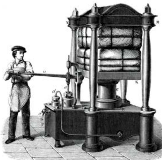
Fig. 62. — Presse hydraulique.
